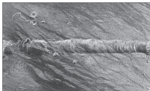
Figura 7. Îmbinare sudată a două plăci din oțel S355, cu grosimea de 8 mm, care au fost îmbinate prin sudare 111 cu electrod rutilic (a. înainte de zincarea termică; b. după zincarea termică)
