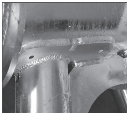
Figura 1. Aspect specific după zincarea termică a suprafețelor oțelului și a suprafețelor îmbinărilor sudate
