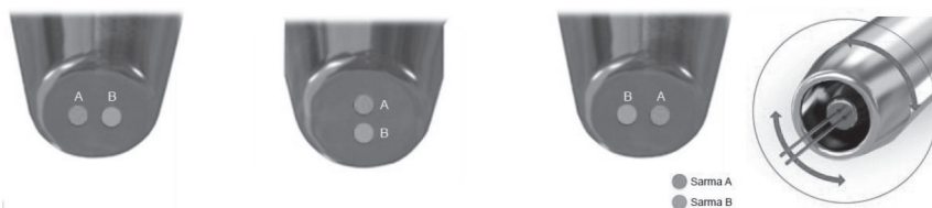
Figura 5. Modalități de poziționare a sârmelor electrod în duză și orientarea acestora [10]
