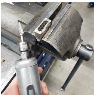
Figura 6. Curățarea matriței înaintea sudării Figure 6. Cleaning the mould before welding
