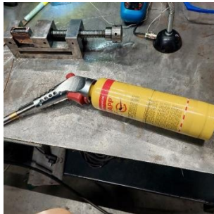
Figura 8. Dispozitivul de aplicare a preîncălzirii Figure 8. The device for applying preheat.
