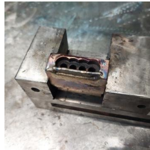
Figura 10. Matrița fixată în dispozitiv și trecerile de sudare Figure 10. The mould fixed in the device and the welding steps
