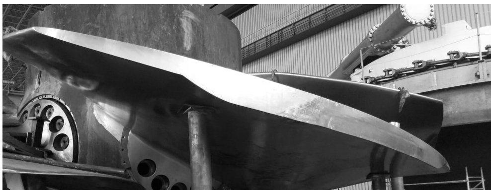
Fig. 1 Paletă de turbină Kaplan de 150 MW Fig. 1 Kaplan runner blade of a 150 MW turbine
