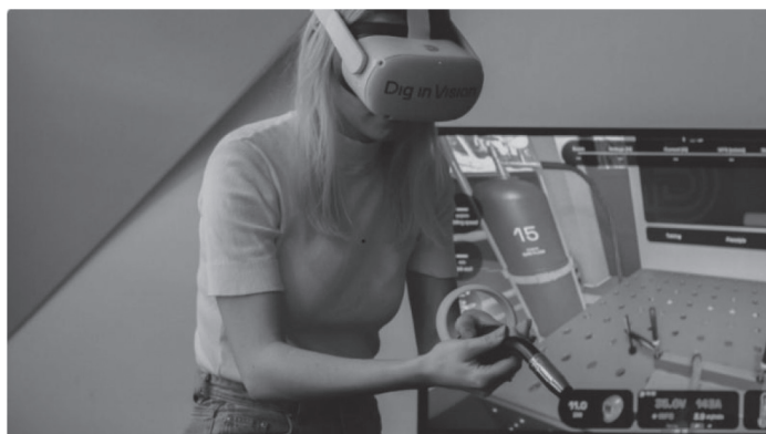
Figura 3. Imagine cu echipament real care folosește realitate virtuală pentru instruirea în sudare [14]
