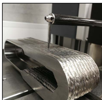
Fig. 8 Rugozitatea suprafeței măsurată folosind un dispozitiv de măsurare a conturului, diametrul sârmei: 1,2 mm Fig. 8 Surface roughness using a contour measuring device, wire diameter: 1.2 mm
