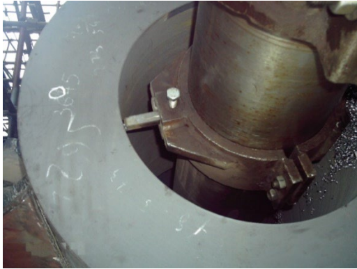
Fig. 7 Prelucrarea interioară prin strunjire pentru pregătirea zonei de montare a rulmenților Fig. 7 Machining of the interior surface for bearings
