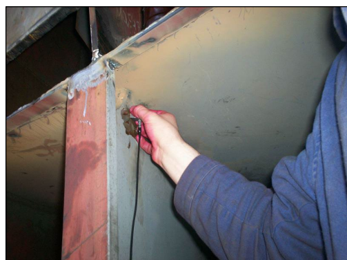
Fig. 9 Imagini din timpul examinării cu ultrasunete Fig. 9 Image taken during the US NDT process
