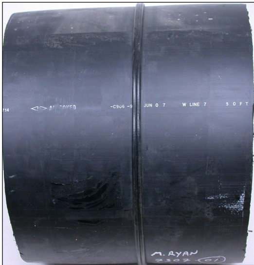
Fig. 7 Îmbinări cu suduri prea subțiri datorită unui contact insuficient
