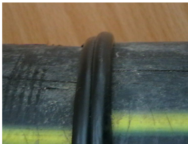
Fig. 11 Forma bavurii în condiții de nealinierie
