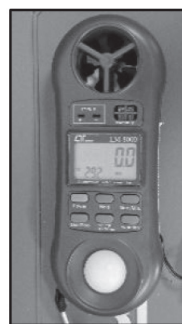
Figura 2. Anemometru utilizat la măsurarea vitezei Figure 2. Anemometer used for measurement of speed
