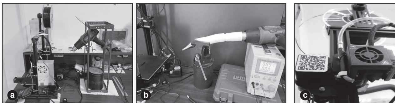
Figura 1. Variantele de surse termice suplimentare propuse: a) Jet de aer cald fără controlarea suprafeței de acțiune; b) Jet de aer cald cu un control minim al suprafeței de acțiune; c) Jet de aer cald cu control ridicat al suprafeței de acțiune
