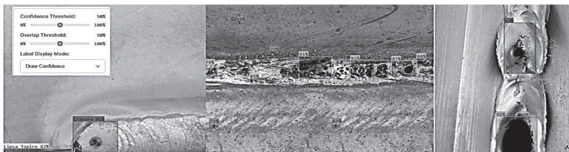
Figura 6. Detectii imperfectiuni de sudare, program Weld Visual Inspection
