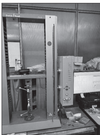
Figura 3. Proba de încercare la tracțiune prinsă pe mașina de universală Zwick/Roell Z005
