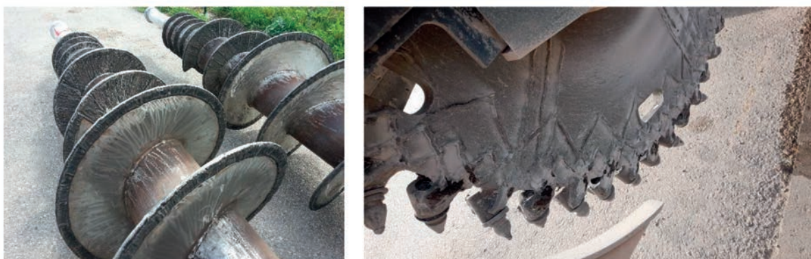
Figura 2. Echipamente de foraj recondiționat prin sudare cu EnDOTec SafeHard 700
