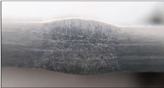
Fig. 3 Macrostructură, proba sudată cu gazul protector Ar Fig. 3 Macrostructure, sample welded with Ar shielding gas
