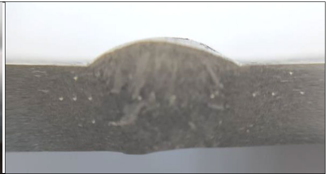
Fig. 4 Macrostructură, proba sudată cu gazul protector Ar+N 2 Fig. 4 Macrostructure, sample welded with Ar+N 2 shielding gas
