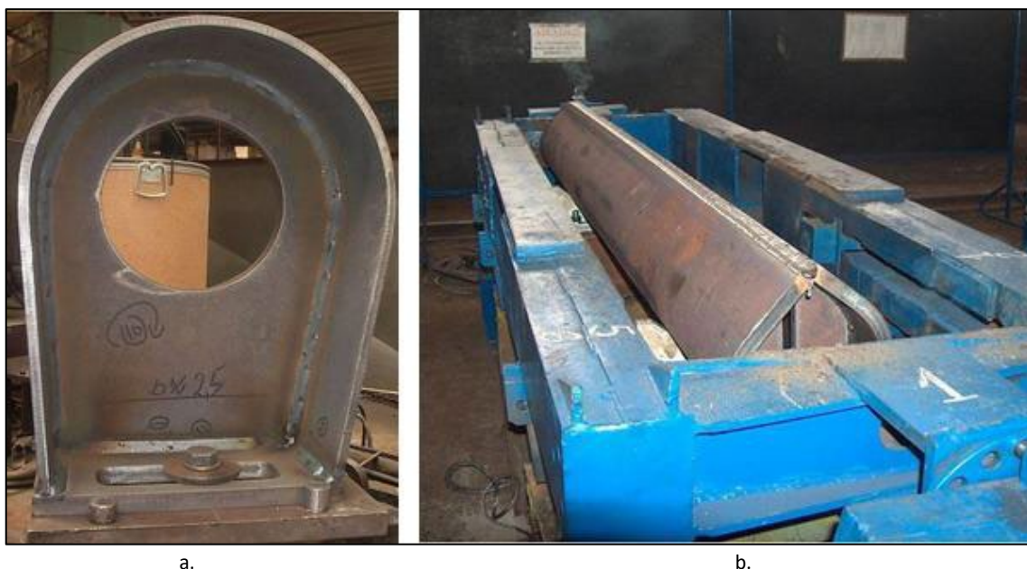
a. b. Fig. 5 Subansambluri ale unor utilaje terasiere produse în România pe sisteme robotizate (a. cadrul unui buldo-excavator; b. grindă pentru scarificatoare)
