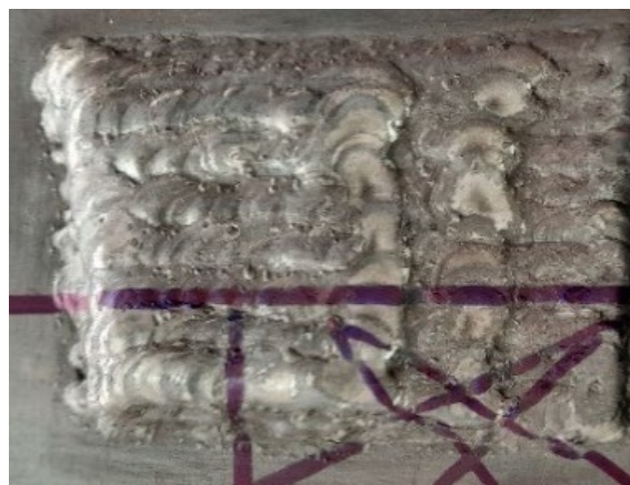
Fig. 2 Aspectul suprafețelor probei încărcate prin sudare cu procedeul WIG
