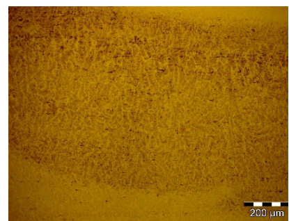
c. sudură c. weld seam
