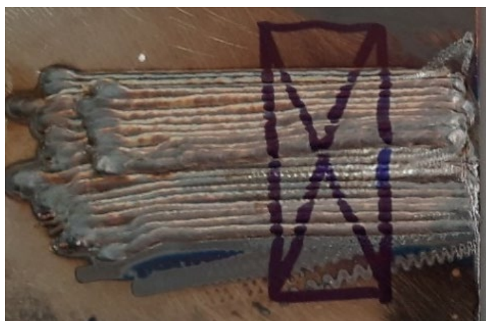
Fig. 3 Aspectul suprafețelor probei încărcate prin sudare cu procedeul LASER
