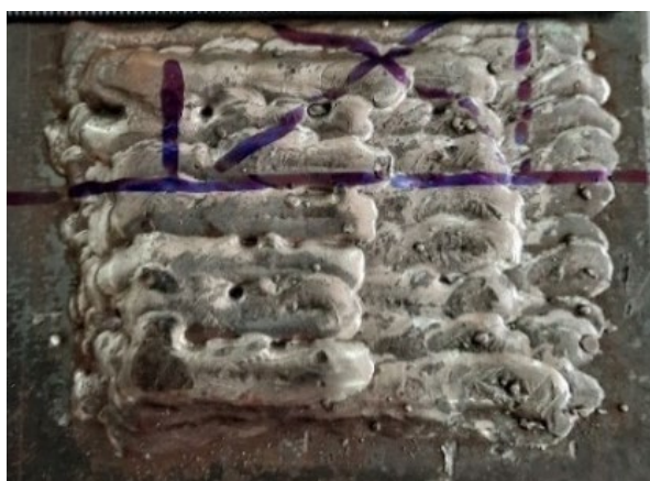
Fig. 1 Aspectul suprafețelor probei încărcate prin sudare cu procedeul MAG
